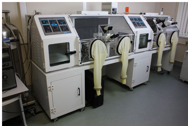
Рис. Гипоксическая (анаэробная) станция для культивирования эукариотических клеток, выполненная на основе двух камер VacTrox со шлюзовыми камерами, встроенным инвертированным флуоресцентным и бинокулярным микроскопами (Институт фундаментальной биологии и медицины, Казанский (Приволжский) федеральный университет)
